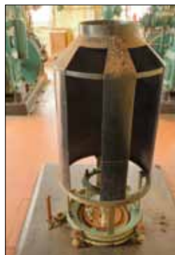
Stålcylindern som genererar fyrkaraktären.
